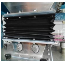
③ 蛇腹特性柔软、耐磨，耐高温400度 上下层不产生共鸣共振现象 减少了由于震动引起的螺丝松动
